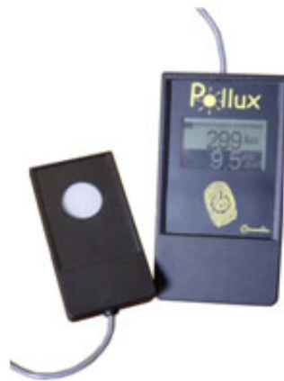
Radiomètre/luxmètre numérique affichant simultanément les valeurs de l'éclairage lumineux et de l'éclairage énergétique (UV-A).
